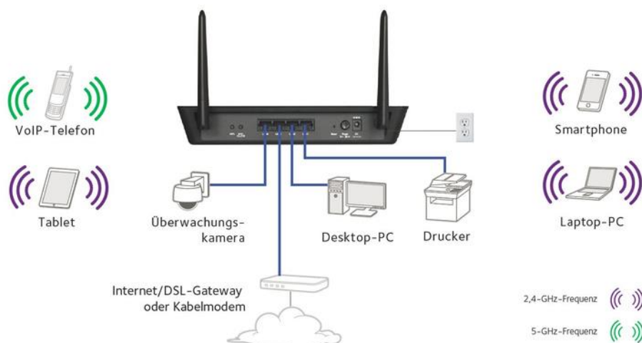
ภาพที่ 2-20 ลักษณะการเชื่อมต่อแอคเซสพอยต์ ที่มา : เอกชัย ไก่แก้ว (2562)
